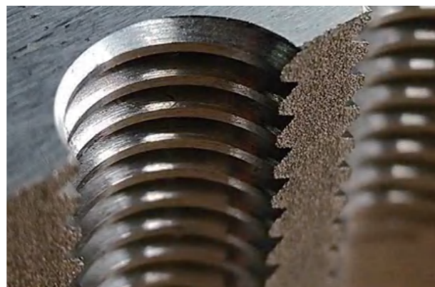
DEREK VER Split Synch Tapping Chuck 德克VER分体式微补偿刀柄攻牙加工效果
